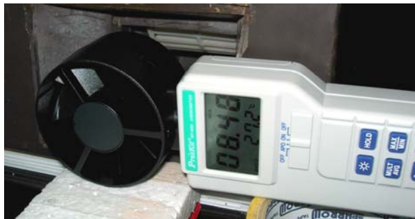
รูปที่ 3.8 แสดงการใช้มาตรฐานความเร็วลมวัดอัตราเร็วของลมและอุณหภูมิ
