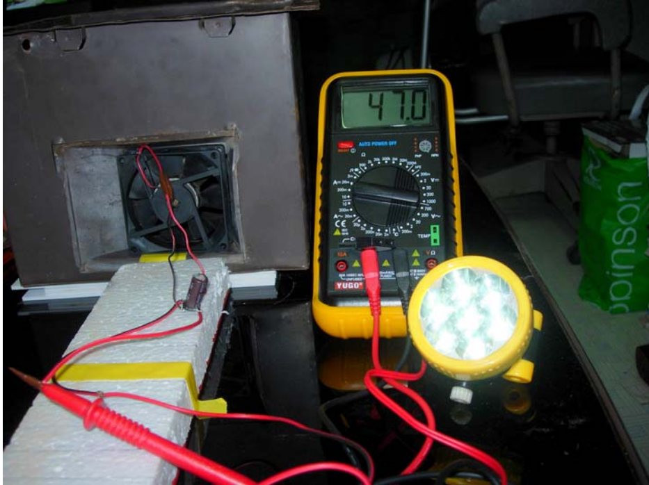
รูปที่ 3.10 แสดงการวัดความต่างศักย์ไฟฟ้าและกระแสไฟฟ้าทั้งไฟฟ้ากระแสตรงและไฟฟ้ากระแสสลับในขณะที่มีโหลดคือหลอดไฟ LED จำนวน 7 หลอด
